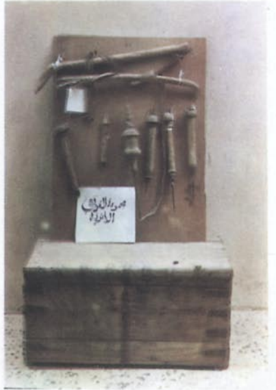
مجموعة المقادح لشقّب الأخشاب. وهي من الأدوات الحرفية الخاصة بالتجار القديم، وكانت تقوم مقام «الدريل» الحديث في عصرنا الحاضر.
